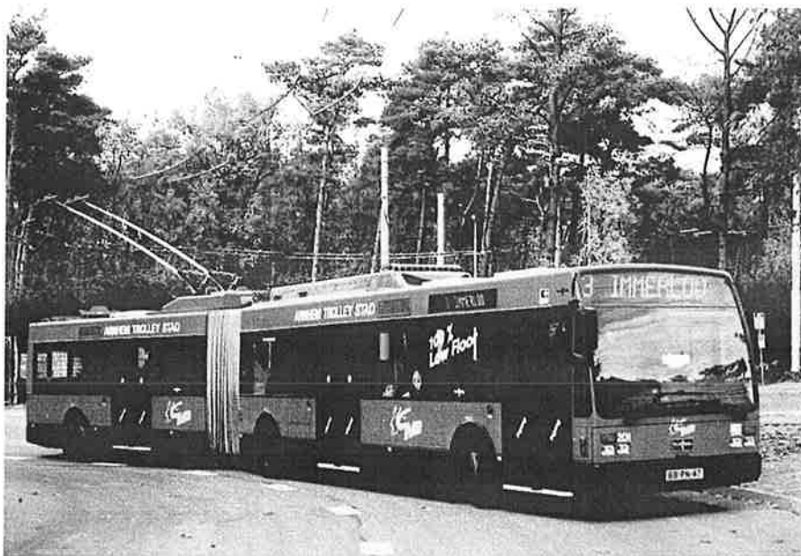
GVM 201 (1994), de trots van de Gelderse Vervoer Maatschappij (hier aan Burgers Zoo in Arnhem op 11 november 1995), is een Van Hool AG 300T duobus (trolley- en dieselbus) met integrale lage vloer. Achttien van deze prachtige wagens werden ook geleverd aan Montreux (Zwitserland). Foto's Luc. Couscheir.
